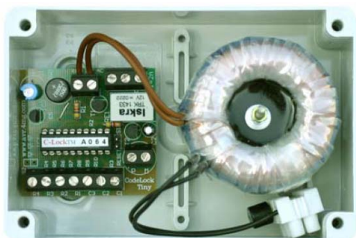
Elektronika CodeLock 10b in toroidni transformator v ohišju, ki ima dimenzije (130 x 90 x 60) mm.
