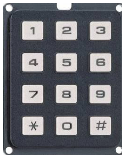
Slika tipkovnice (51 x 64) mm
